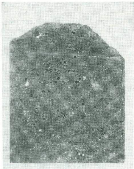
Рис. 43. Боксит маркий, вишнево-красный. Месторождение Красная Шапочка. \text{Al}_2\text{O}_3 — 55%, \text{SiO}_2 — 2,5%
