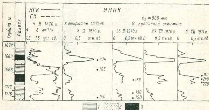
Рис. 31. Результаты повторных измерений ИННК в условиях нефтяных месторождений с высокой минерализацией пластовых вод при вскрытии пласта на минерализованной промывочной жидкости.
