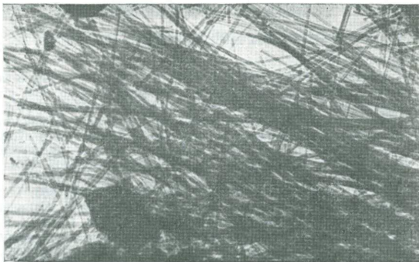
Рис. 11. Электронно-микроскопический снимок суспензии палыгорскита из серного месторождения Шакарлык-Астана, Южный Узбекистан. Ув. 16000 (Смирнова, 1970).
