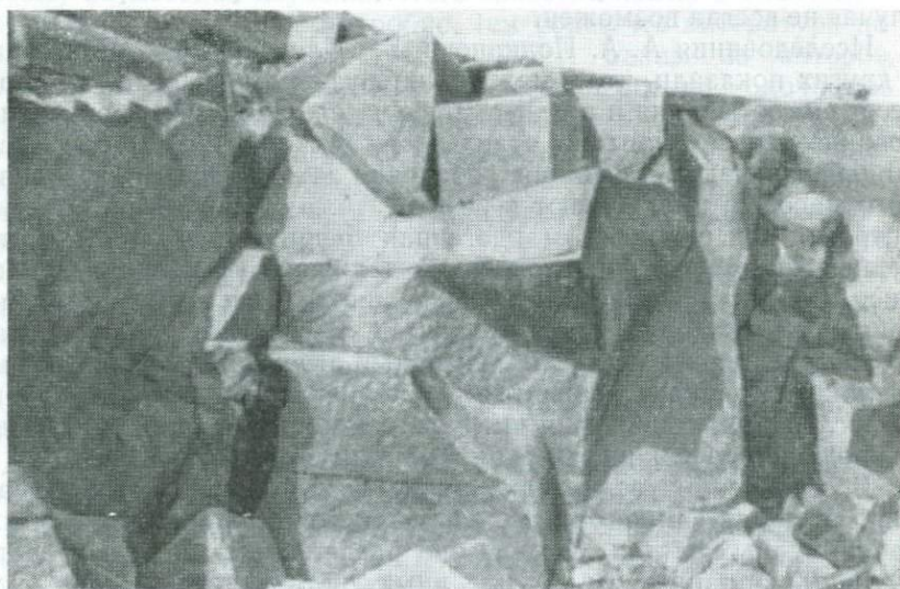
Фиг. 21. Блочность уманского гранита, Украина, карьер Старые Бабаны В глыбе в центре фотографии видна серия зарубок, подготавливающих ее для клин-ового раскола
