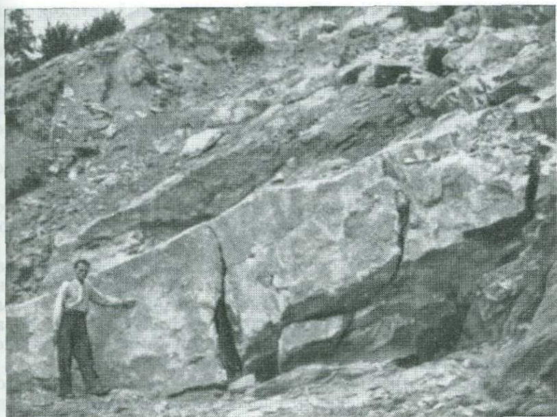
Фиг. 22. Характер трещиноватости мрамора на месторождении Деловое. Фото И. С. Солонинко
