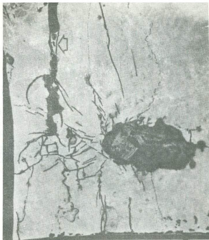
Фиг. 12. Асимметричное развитие трещин в известняке в случае, когда кумулятивный взрыв направлен в сторону открытой трещины. Трещины заполнены металлом обсадной трубы и его окислами. Стрелкой показана естественная трещина; ширина изображенной поверхности составляет 9 см.
