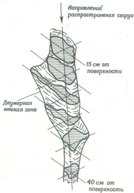
Ф и г. 10. Воздействие взрыва кумулятивного заряда с конической выемкой на гидротермально измененную гранитную породу с анизотропной динамической прочностью.
