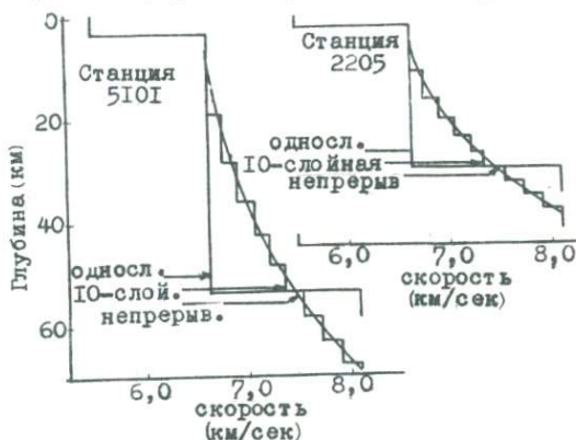
Р и с. 6. Максимальное распределение скорости в зависимости от глубины, вычисленное по годографам станций 5101 и 2205. Вычисления сделаны для случаев, когда между верхней преломляющей границей и поверхностью Мохо среда разбита на 10 слоев или скорость непрерывно увеличивается с глубиной.
