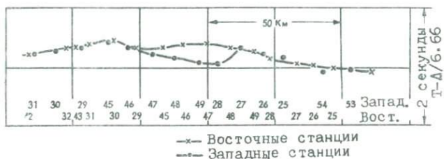
Р и с. 8. Совмещенные графики временных задержек для центральной части структуры по верхней преломляющей границе. Заметно неизбежное несоответствие.
