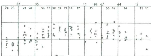
Р и с. II. Профиль временных задержек для волны P_n по западным станциям.
