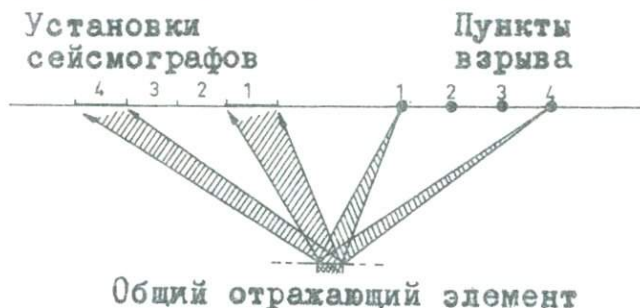
Рис. 1. Схема наблюдений при методике общей глубинной точки.
