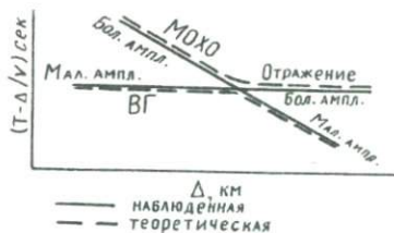
Р и с. 20. Иллюстрация использования амплитудной корреляции для идентификации отраженных и преломленных волн. Поскольку последующие волны систематически больше по амплитуде, чем первые вступления, то они должны быть отнесены к типу отраженных.
