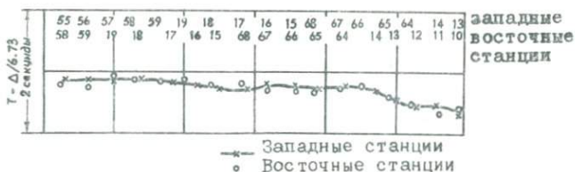
Р и с. 7. Совмещенные графики временных задержек для восточной части структуры верхней преломляющей границы.
