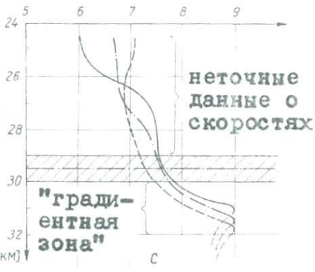
Рис. 14. а - Переходная зона с градиентным слоем. Отдельные варианты получены различными способами интерпретации; б - Переходная зона с градиентным слоем при предположении, что граница / SCD / расположена на 500 м выше; с - Возможное распределение горизонтальных скоростей в переходной зоне при анизотропии в II-15% . ----- зависимости с различными значениями начальной скорости /определенные по интегралу Вихерта-Герглотца на основе рис. 13/; - - - - - зависимости, характеризующиеся в большинстве случаев отрицательным градиентом /построены лучевыми способами систематическим перебором/.
