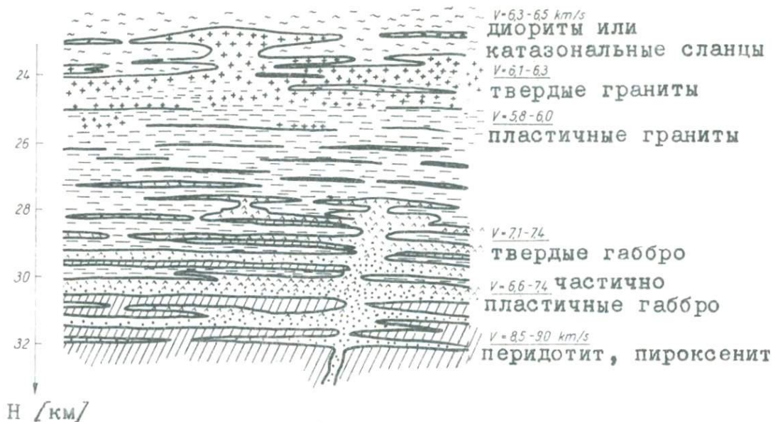
Рис. 29. Схематический разрез переходной зоны кора — мантия; количество пластин уменьшено, их мощность увеличена.
