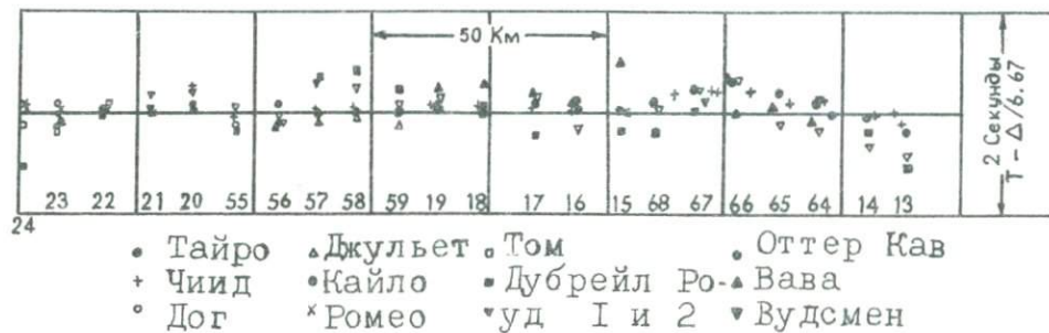
Рис. 5. График временных задержек для верхней преломляющей границы; восточные станции.
