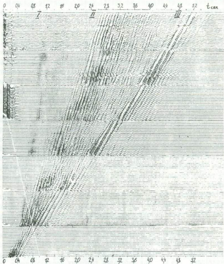
Рис.6. Волновое поле в реальной модели типа А. Приемники и источник (взрывной снаряд) – одиночные. Интервал наблюдений 0–800 м.
