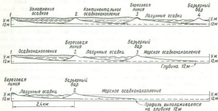
Ф и г. 25. Схематические поперечные разрезы, показывающие стадии формирования регрессивной толщи барьерного бара [196].
