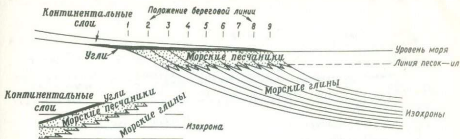
Ф и г. 11. Стабильное положение поверхности осадконакопления при равномерном поступлении осадков [115 с изменениями].
