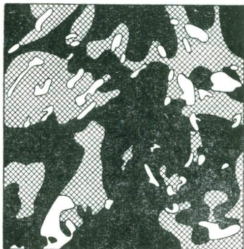
Рис. 24. Пример генерализации леса по аэроснимкам: а — исходный аэроснимок, б — генерализация по предельно допустимой нагрузке карты, в — генерализация по цензам инструкции по топографической съемке
