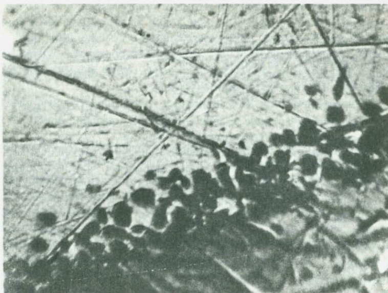
Рис. 22. Образование пор в серебре в результате нагревания системы золото – серебро
