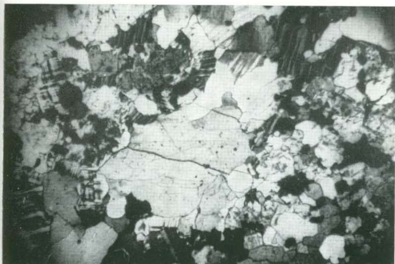
Рис. 4. Метасоматическое развитие порфировидных выделений агрегатов зерен кварца.
