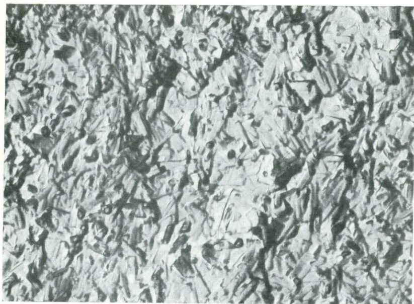
Фото 25. Поверхность излома массивного галлаузита с беспорядочной ориентировкой полей кристаллов округлого и округло-углового поперечного сечения. \times 18\ 000 .
