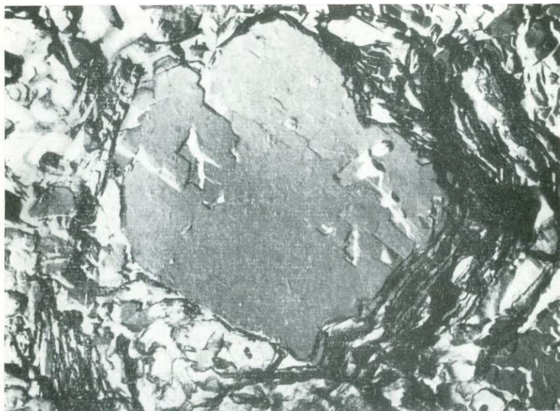
Фото 64. Полная псевдоморфоза каолинита по относительно небольшой табличке биотита из зоны полной каолинизации чудново-бердичевских гранитов. \times 12\ 500
