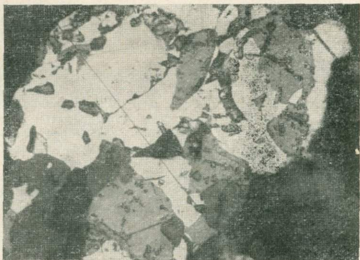
Фиг. 24. Выделения стефанита (светло-серое) в халькопирите (белое). В стефаните наблюдаются мелкие включения самородного серебра, образовавшиеся в результате светотравления. Темно-серое — сфалерит, черное — кварц. Полированный шлиф, увел. 750 с иммерсией (Мыльняковско-Хоркиринское месторождение)
