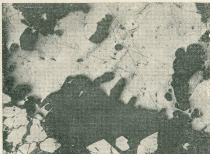
Фиг. 27. Пересечение цинкениита (серое основное поле), зелигманитом (ветвящиеся рельефные прожилки несколько более темные, чем цинкениит). Черное — кварц, белые идиоморфные кристаллы — арсенипирит. Полированный шлиф, увел. 50 (Кличкинское месторождение)
