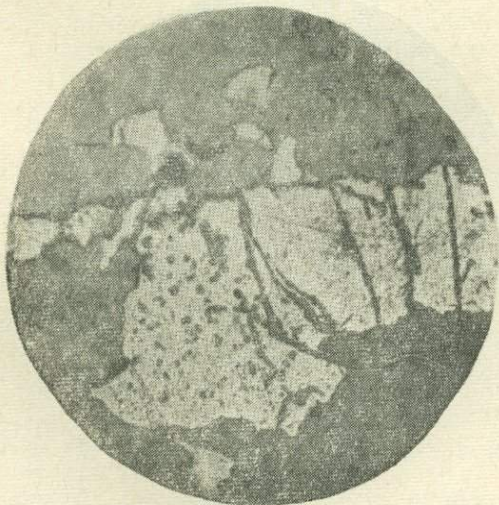
Рис. 14. Зерно арсенопирита, по которому развивается халькопирит.
