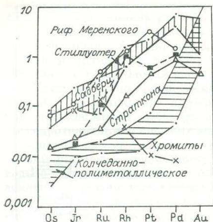
Рис. 3. Распределение благородных металлов на одном из колчеданно-полиметаллических месторождений (по данным авторов) и типичных медно-никелевых и хромитовых месторождений (по данным [Надрет, 1984; Норман и др., 1982]).
