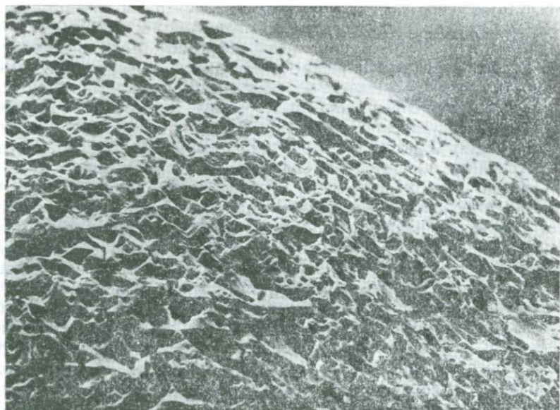
Рис. 34. Особенности микроморфологии поверхности «сильно изношенных» зерен граната из шлихового ореола
