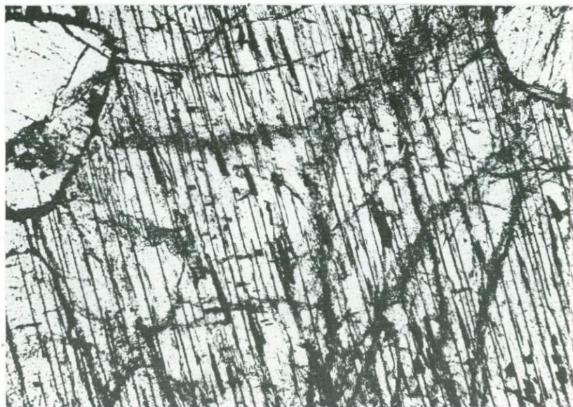
Фото 4. Пластинчатые выделения шпинелидов в клинопироксене из гранитизированного лерцолита трубки «Обнаженная» (обр. О-6; шлиф, без анализатора, ув. 50)
