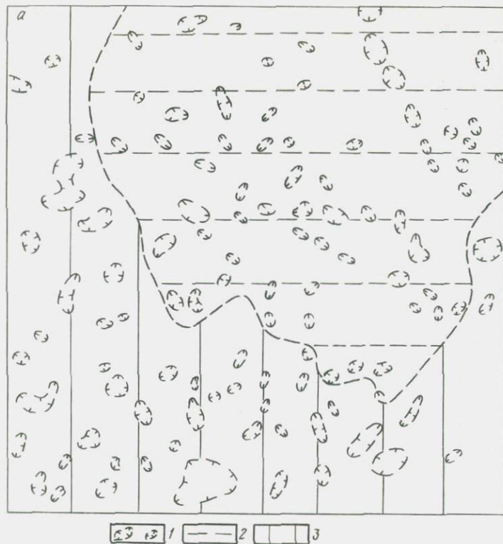
Рис.2. Картошемы: геоморфологическая (а) и четвертичных отложений (б), составленные по результатам дешифрирования аэроснимка масштаба 1:17500; а — 1 — просадочные и суффозионные западины; 2 — плоскозападинная равнина проблематичных (лессовидных) отложений; 3 — пологоволнистая водно-ледниковая равнина (Могилевская обл., БССР); б — 1 — современные болотные отложения: торф, гиттии; 2 — верхнечетвертичные проблематичные (лессовидные) отложения: пески, супеси пылеватые; 3 — среднечетвертичные водно-ледниковые отложения времени отступления московского оледенения, пески
