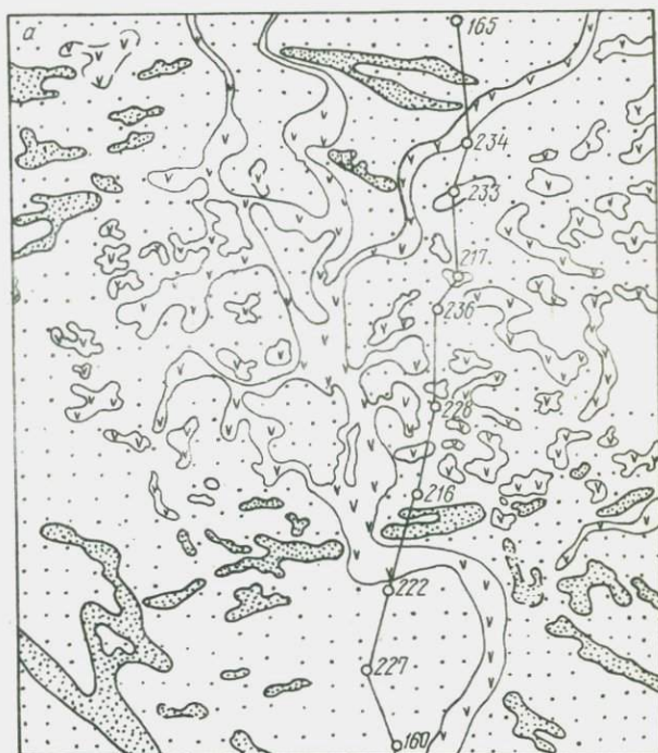
Рис.2. Отображение центральной части северной линзы Житковичского месторождения бурых углей в строении ландшафта и кайнозойских отложений: а — геологическая карта четвертичных отложений; б — геологический разрез по линии скв.165—скв.160
