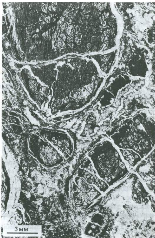
Рис. 43. Микрофотография кимберлитов Мауд-Крик с округлыми серпентинизированными дунитовыми нодулями в основной массе, сложенной карбонатом, серпентином, хлоритом и вторичной шпинелью (GSWA 65992).
