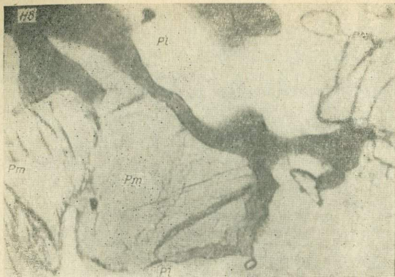
Рис. 36. Развитие роговой обманки на контакте пироксенов с плагиоклазом. Без анализатора, увел. 20, обр. 88-1.
