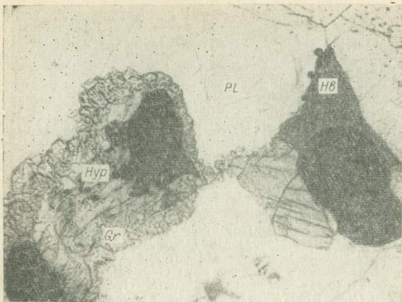
Рис. 38. Оторочка граната на контакте магнетита и гиперстена с плагиоклазом. Без анализатора, увел. 50, обр. 331/1, р. Гонам.
