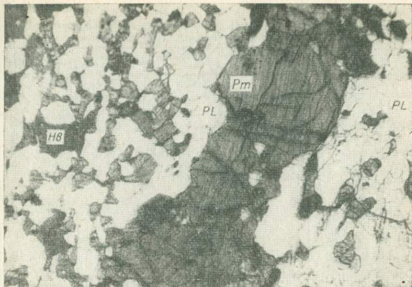
Рис. 14. Диопсид-плагиоклазовая меланократовая оторочка на контакте плагиоклазовой жилки с амфибол-диопсид-плагиоклазовым основным кристаллическим сланцем. Без анализатора, увел. 9, шл. В-74-3. Правый берег р. Алдан в 2 км ниже устья р. Нимгеркан.
