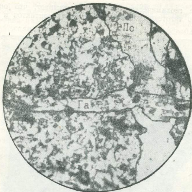
Рис. 52. Последовательность образования пироксеновых (Ps) и амфиболовых (гастингситовых — Ga) прожилков в роговике. М-ние Койташ; ув. X 20, николи+.
