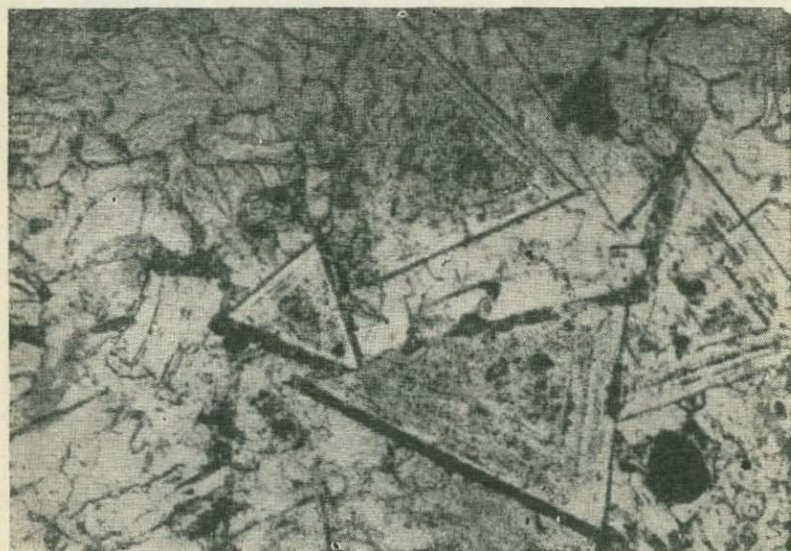
Рис. 34. Сечения тетраэдрических кристаллов цуннита Самаргинского поля. Шл. № 3042. Без анализатора. Ув. \times 110 .
