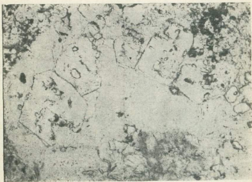
Рис. 33. Формы сечений кристаллов цуннита Бринеровского поля. Шл. № 3982. Без анализатора. Ув. \times 45 .
