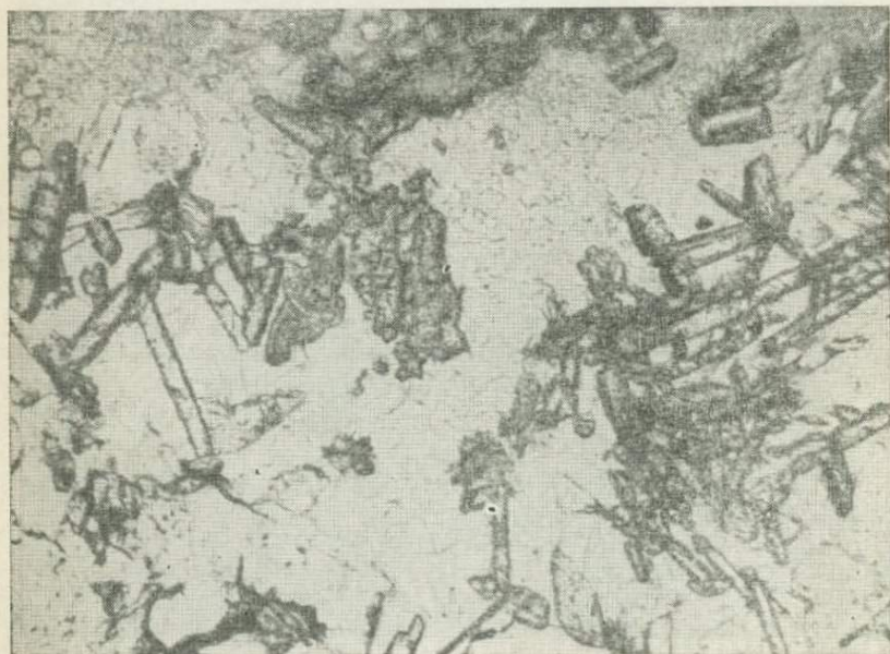
Рис. 26. Длиннопризматический диаспор. Самаргинское поле. Шл. № 3041. Без анализатора. Ув. \times 110 .
