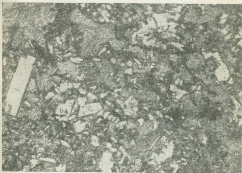
Рис. 5. Серная руда; идиоморфные прозрачные пластинки — диаспор; серая масса — сера, темная — сульфиды. Шл. № 3751. Без анализатора. Ув. \times 50 .
