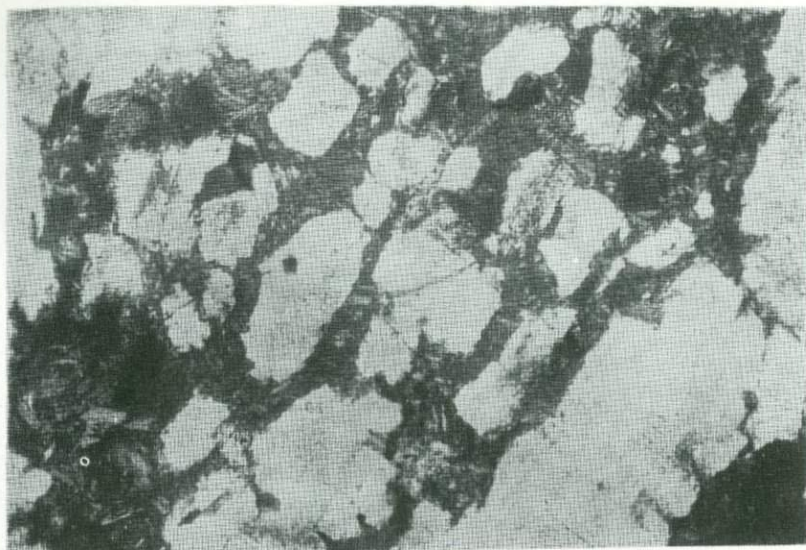
Фиг.50. Характер биотитизации гранитов Белухинского массива. Увел.30, без анализатора
