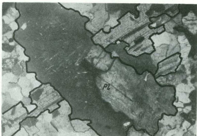
Фиг.6. Развитие агрегатных порфиробластов плагиоклаза (Pl) после трещинного биотита в сиенито-диоритах. Увел.30, николи скрещены
