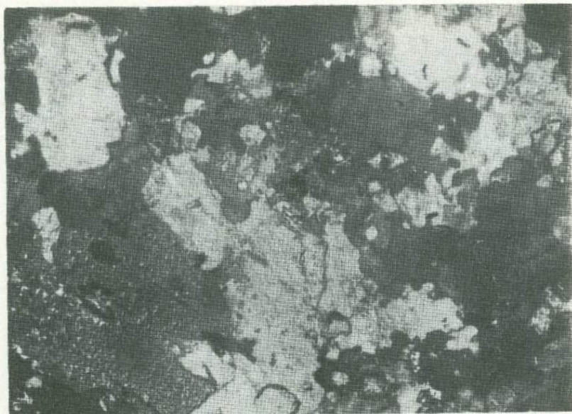
Фиг.10. Переработка трещинного биотита в аплитовой минеральной ассоциации. Увел.30, николи скрещены
