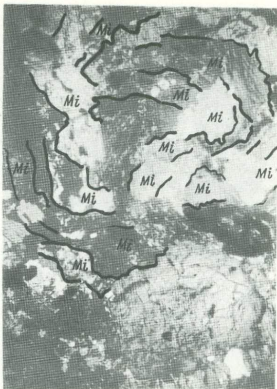
Фиг. 36. Пластические деформации концентрического характера гранитов Пуринского массива. Увел. 30, николи скрещены
