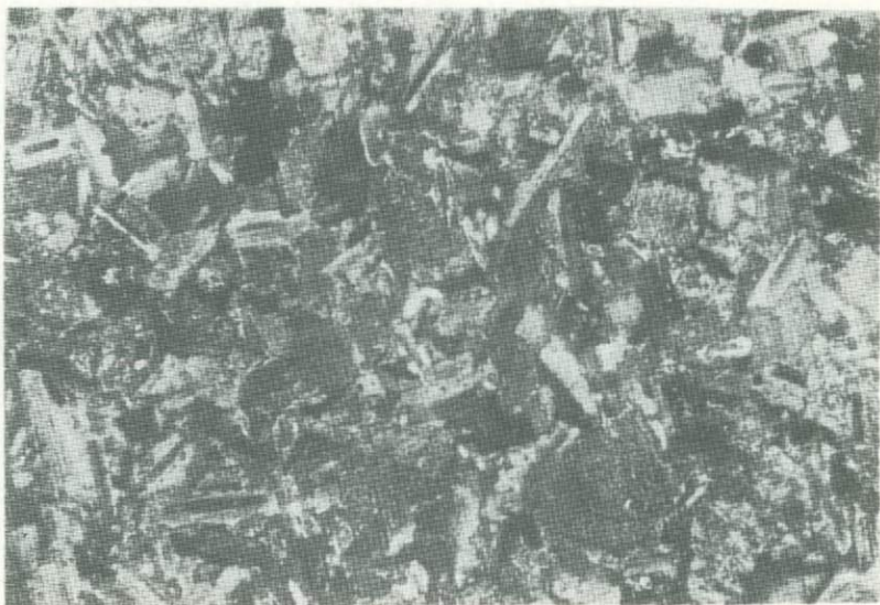
Фиг.17. Долеритоподобная структура пород Шахтаминского массива. Увел.30, николи скрещены
