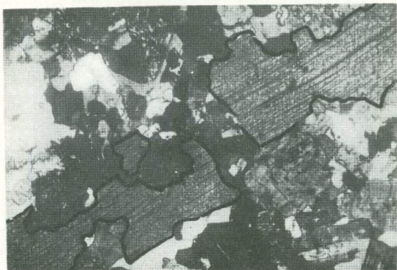
Фиг.29. Трещинный биотит в гранодиоритах Алиинского массива, поперечный срез. Увел.30, николи скрещены
