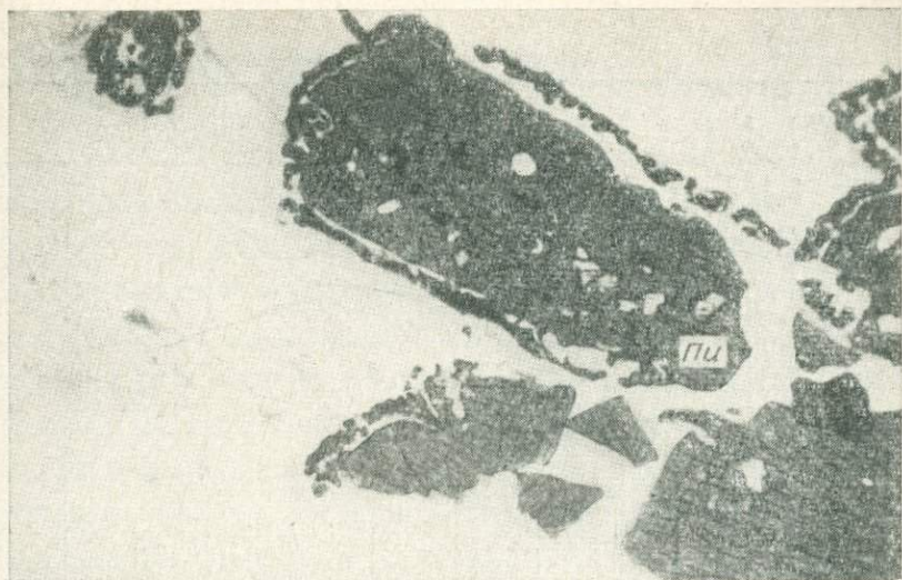
Рис. 10. Реакционная кайма из мелких зерен арфведсонита, граната, канкринита, цеолитов и альбита вокруг призматических зерен эгирин-авгита (Пи). Верхне-Бурульзайский массив. Нефелиновый сиенит. Ув. 37, без анализатора. Обр. 46/0.
