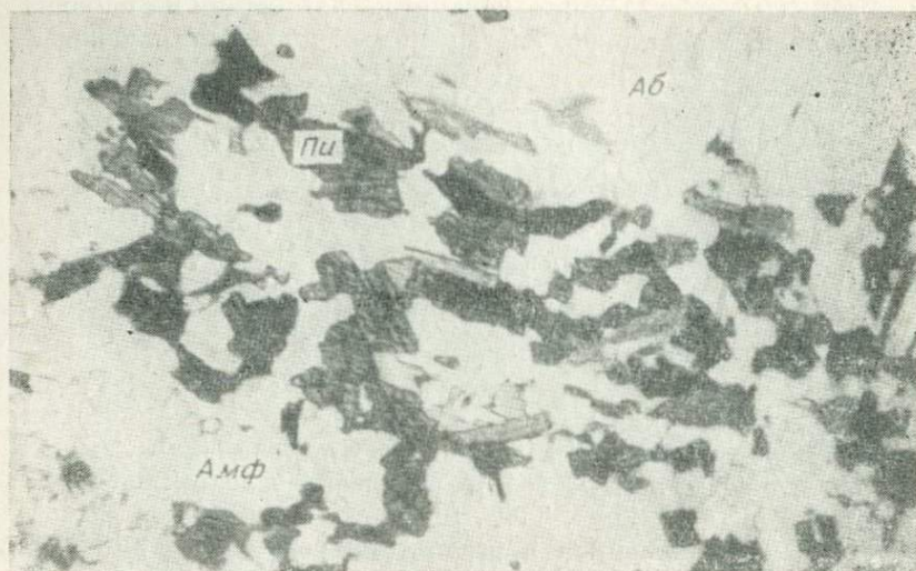
Рис. 16. Реликты амфибола (Амф) и пироксена (Пи) в альбите (Аб). Альбитизированный сиенит. Ув. 37, без анализатора. Обр. 695/0.
