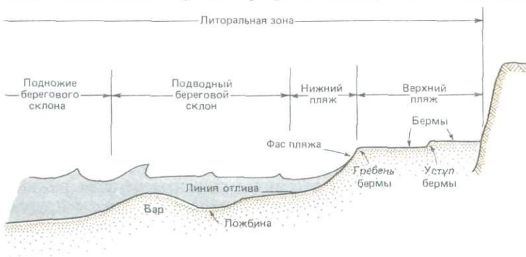
Рис. 10-5. Элементы поперечного профиля пляжа – терминология [606].
