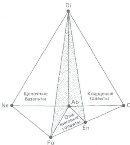
Рис. 7-6. Нормативный базальтовый тетраэдр Йодера и Тилли [1155], показывающий положение щелочных базальтов, оливиновых и кварцевых толеитов в координатах нормативных минералов. Оливиновые толеиты занимают субтетраэдр Fo–Di–Ab–En.
