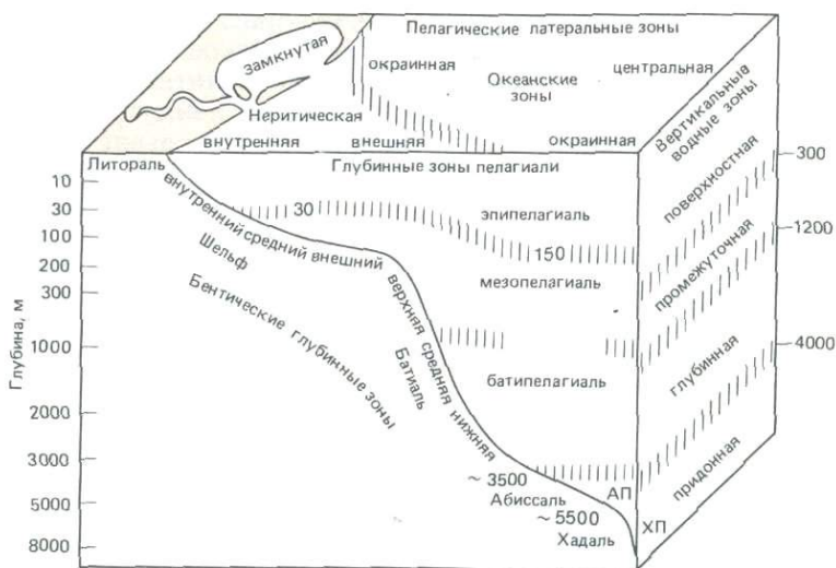
Рис. 8-16. Классификация основных морских бентических и пелагических обстановок. Положение границ обычно варьирует в разных исследованиях. АП – абиссопелагиаль, ХП – хадопелагиаль [287].
