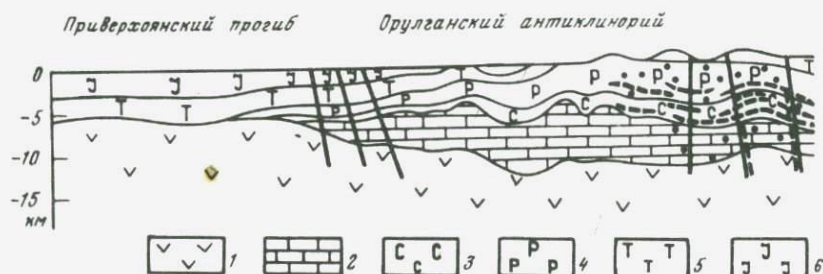
Рис. 7. Палеогеологический разрез в эпоху формирования жил малосульфидной золото-кварцевой формации в южной части Орулганского антиклинория
