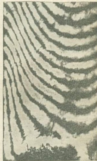
Рис. 9. Восстановленные с одновременно полученных голограмм интерферограммы пламени спиртовки с введенными в него парами калия.
