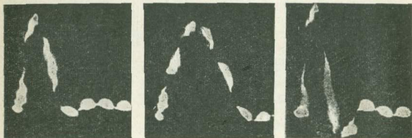
Рис. 16. Осциллограммы импульсов излучения рубинового лазера до и после кюветы, а также импульса ВКР.
