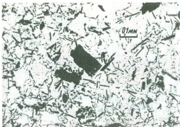
Р и с. 49. Тыловая рибекит-альбитовая зона колонки щелочного метасоматоза биотитового гранита, полученной под действием фторидно-натриевого раствора (оп. 43/1, 1,0 m NaF); фото в иммерсии при одном никеле
