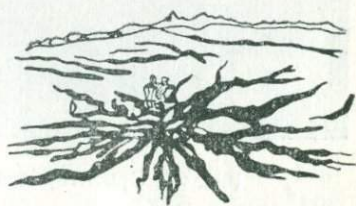
Рис. 35. Трещины, вызванные радиальными (толчкообразными) движениями, ветвящиеся.
