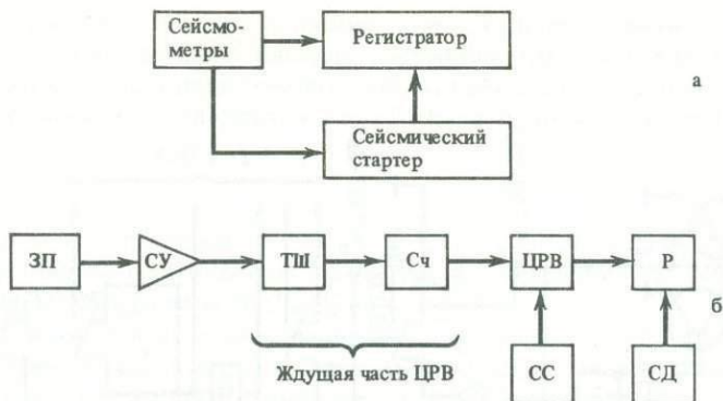
Рис. 1. Блок-схема ждущего сейсмографа а – простейшего; б – сильных землетрясений с комбинированным запуском
