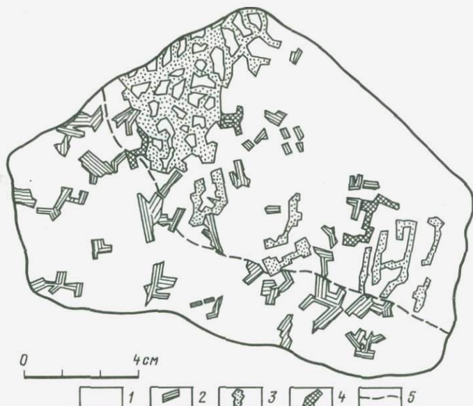
Рис. 6. Текстурные особенности рисчоррита, контактирующего с уртитом 1 — нефелин; 2 — клинопироксен; 3 — калишпат (порфиробластового облика); 4 — сфен; 5 — контакт рисчоррита с уртитом
