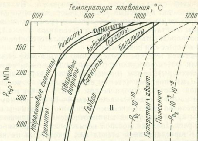
Рис. 66. Режим кристаллизации магм различного типа в вулканической (I) и плутонической (II) фациях.
