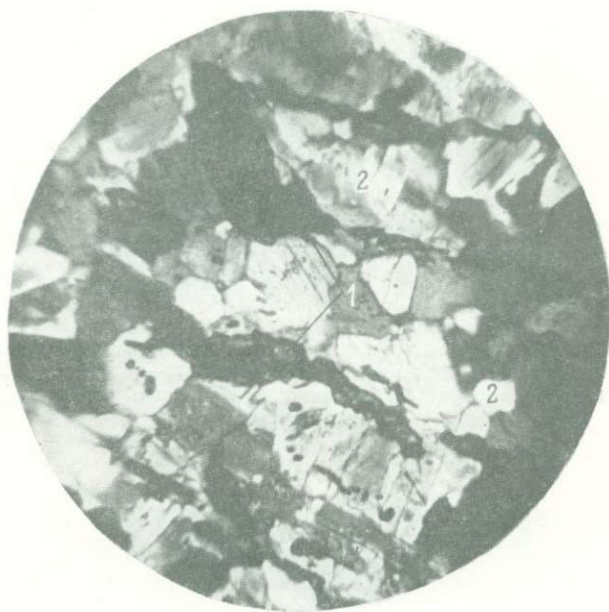
Рис. 24. Рутиловые прожилки (1), секущие зерна роговой обманки (2) в роговообманковом прожилке. Истоки р. Ильча. Николи \parallel , увел. 70.
