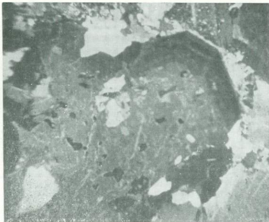
Рис. 60. Турмалин, содержащий реликты полевых шпатов и кварца. Гранит грейзенизированный. Николи \parallel , увел. 35.
