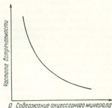
Рис. 67. Основной тип вариационной кривой распределений содержаний акцессорных минералов.
