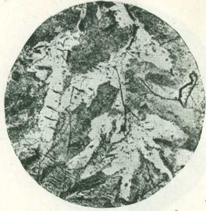
Рис. 56. Перистый свинцовый сульфид (белый цвет), замещающий галенит. Tintic, Utah. Увеличение в 24 раза.
