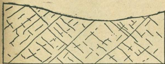
Рис. 39. Вертикальный разрез сопряженной системы трещин.
