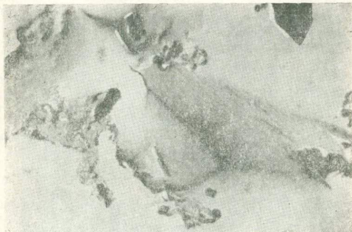
Рис. 2. Кварц скрытокристаллический. Электронномикроскопический снимок угольной реплики с естественного скола кварца (обр. 147, увеличение 11000).
