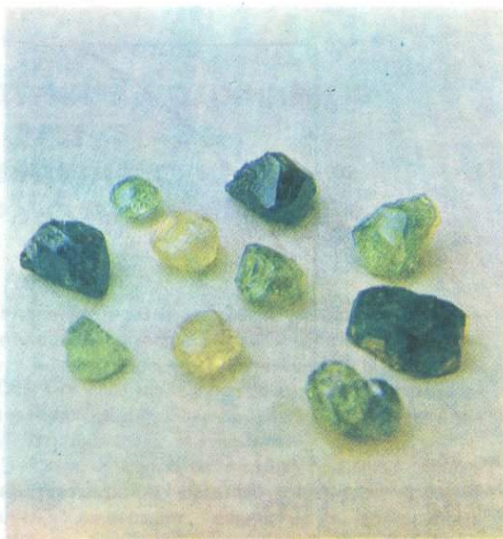
Рис. 88 Кристаллы хромсодержащего иттрий-алюминиевого граната, выращенные методом флюса
