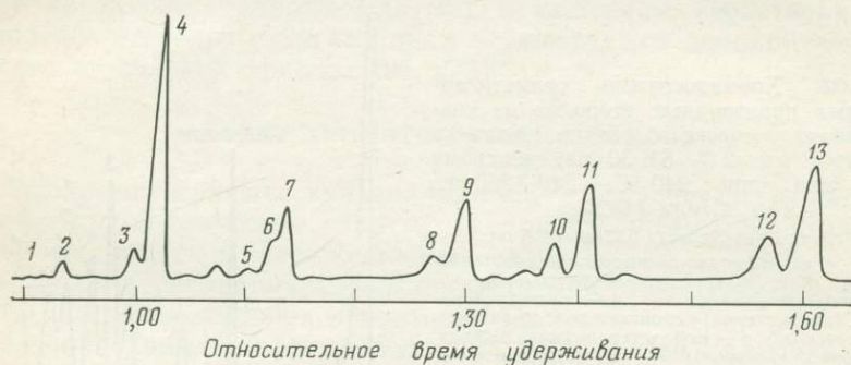
Рис. 34. Хроматограмма триметилсилильных эфиров стеролов из современного осадка бухты Баффин, Канада. Стеклоянная капиллярная колонка 20 м×0,3 мм, SE-52, 230 °С [157].
