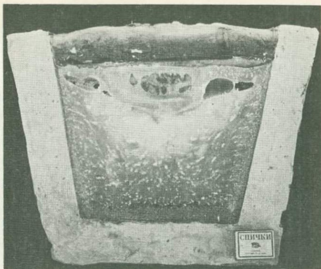
Р и с. 15. Вертикальный разрез отливки парафина в закрытую со всех сторон толстостенную форму. В результате уменьшения объема остывающего расплава, в верхней части отливки, под коркой заковки возникла субгоризонтальная зона растяжения, произошел отрыв оседающего расплава от корки заковки и образовались многочисленные усадочные раковины
