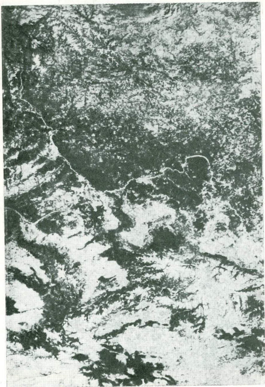
Фото 1. Фрагменты разносезонных телевизионных космических снимков с ИСЗ системы «Метеор» Западной Сибири, отражающие по смене фототона изменение уровня грунтовых вод.
