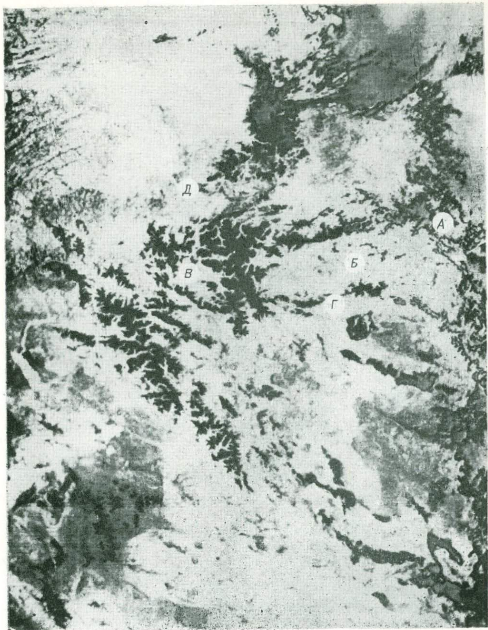
Фото 7. Фрагмент телевизионного снимка с ИСЗ системы «Метеор-28» В-4607 (май, 1978 г.), преобразованного на ЭВМ (ЦОГИ ВЦ СО АН СССР) по программе «Фильтр». Темный фон — зоны склоновых аккумулятивных процессов с переотложенными ко-рами выветривания.
