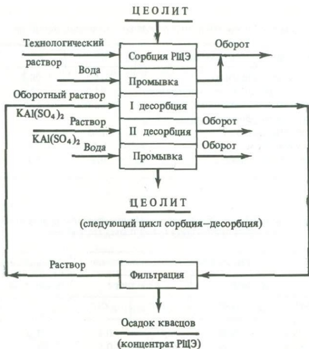
Р и с. 30. Принципиальная технологическая схема концентрирования РЩМ из растворов сложного состава
