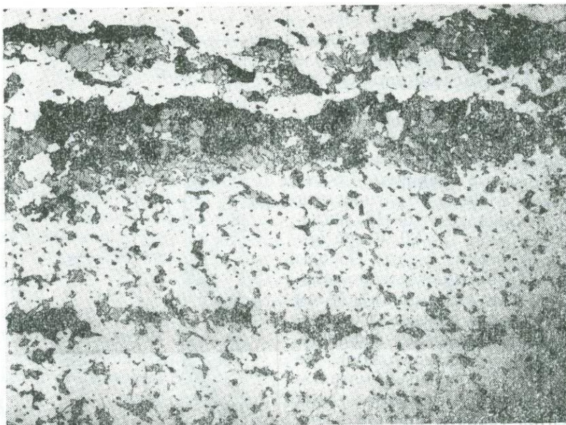
Рис. 8. Тонкополосчатое чередование биминеральных магнетитовых кварцитов и магнетит-анатит-пироксеновых гнейсов. Татария, Ульяновская площадь, скв. 2217. Увел. 13
