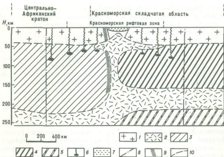
Рис. 42. Гипотетическая модель глубинного строения Красноморской рифтовой зоны: 1 — континентальная кора; 2 — астеносфера; 3 — литосферная часть мантии; 4 — литосферная часть мантии, активная в период развития красноморид (PR 2 ); 5 — верхняя мантия, активная в период развития красноморид; 6 — магматически активные зоны на дорифтовом этапе развития Красноморской рифтовой зоны; 7 — осадки рифтовой впадины; 8 — предполагаемые контуры тектоносферы, активной на дорифтовом этапе развития; 9 — шовная зона в литосфере между Центрально-Африканским кратоном и Красноморской складчатой областью; 10 — условная граница «слоев» тектоносферы
