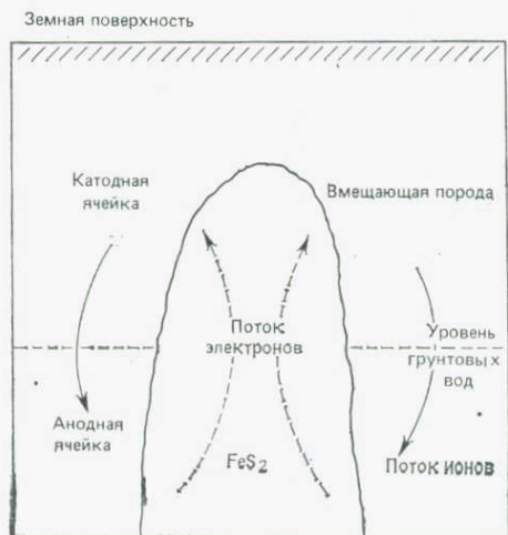
Рис. 6.20. Механизм образования потенциалов самопроизвольной поляризации в пирите. Ток и поток ионов в окрестности рудного тела определяются разностью потенциалов окисления между веществами в растворе выше и ниже уровня грунтовых вод. (Из работы [30] с изменениями.)
