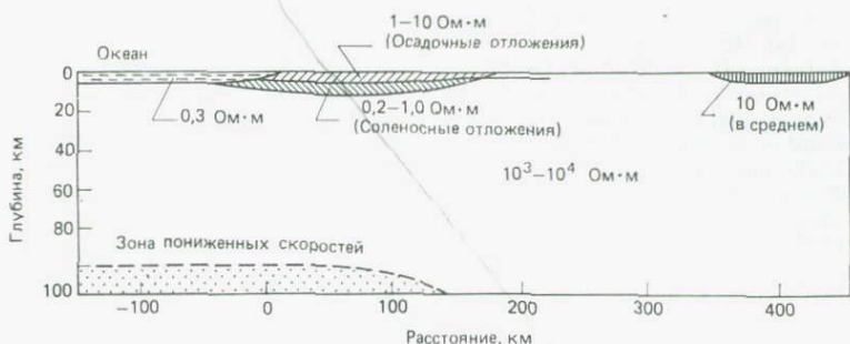
Рис. 7.18. Упрощенный геоэлектрический разрез по профилю, пересекающему континентальный шельф Новой Шотландии и залив Фанди. Построен по результатам анализа магнитотеллурических вариаций с периодами 1—60 мин [18].
