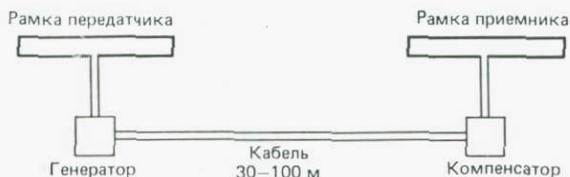
Рис. 7.11. Установка системы Слинграм, предназначенной для выполнения электромагнитной съемки методом горизонтальной петли.
