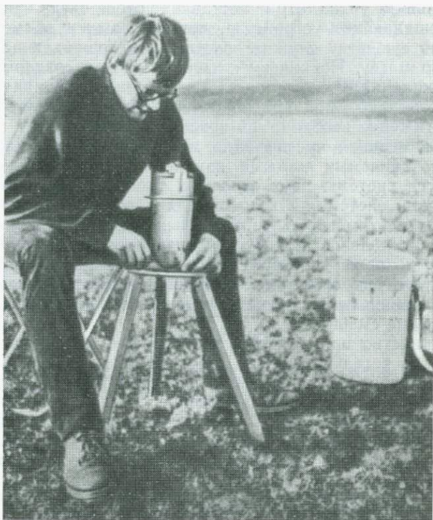
Рис. 3.5. Исследования с гравиметром Уордена в Гренландии.
