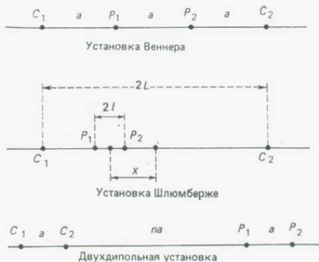
Рис. 6.6. Некоторые электродные установки, часто используемые в исследованиях методом сопротивлений. Символы C_1 , C_2 и P_1 , P_2 обозначают положения токовых и потенциальных электродов соответственно.
