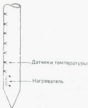
Рис. 9.1. Зонд для измерения теплового потока в мягких осадках океанического дна.
