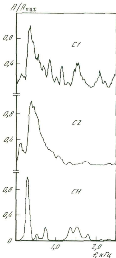
Рис. 1. Обзорная картина изменения регистрируемых параметров на различных стадиях разрушения (мраморизованный известняк)
