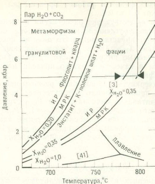
Рис. 6. Устойчивость ассоциации флогопит+кварц+энстатит+К-полевой шпат+пар в системе K_2O-MgO-Al_2O_3-SiO_2-H_2O-CO_2 , рассчитанная по модели идеального раствора (ИР) H_2O+CO_2 и по уравнению состояния МРК Хансенем и др. [22] на основании экспериментальных данных Лута [41] для X_{H_2O}=1 . В обоих случаях рассчитанные кривые равновесия согласуются с результатами обратимых экспериментов Болен и др. [3] при X_{H_2O}=0,35 . Из диаграммы следует, что молярная доля H_2O в метаморфических флюидах гранулитовой фации, сосуществовавших с ортопироксеном и биотитом в кварц-полевошпатовых породах, была ниже 0,35.
