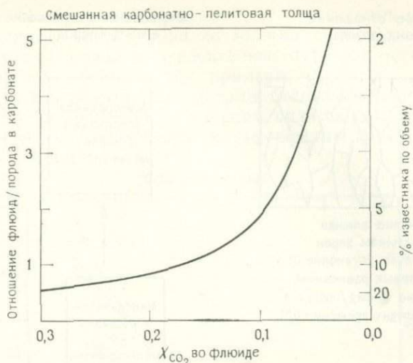
Рис. 3. Влияние объемной доли известняка в осадочном разрезе на максимальные наблюдаемые величины X_{CO_2} во флюиде и отношение флюид/порода.
