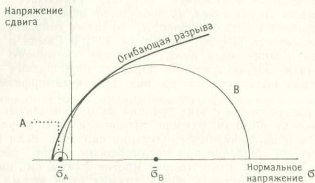
Рис. 1. Диаграмма цикла Мора, схематически иллюстрирующая положение огибающей разрыва для метаморфической породы. Сегменты окружности А и В отвечают областям напряжений для случаев слабого и сильного отклоняющего напряжения и демонстрируют связь разрыва растяжения со средним напряжением на разрыв (например, P_f > P_i ) и сдвига со средним напряжением сжатия ( P_f < P_i ) соответственно.
