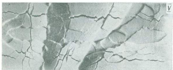
Рис. 68. Поэтапное развитие модели С-11 взаимно пересекающихся структур (грабенов): I — начальное состояние поверхности модельной толщи; II—III — этапы развития двух первичных грабенов; IV—V — то же, вторичного грабена
