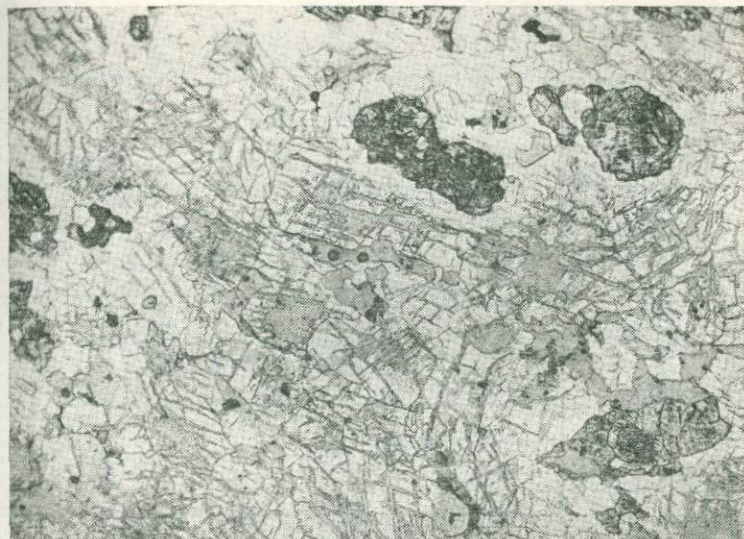
Рис. 1. Развитие хлорита по трещинкам спайности в полевом шпате.
