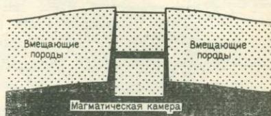
Рис. 99. Схема образования магматического купола и производной кальдеры, полученная на основании данных по вулканическим центрам о-ва Малл (Шотландия) и горы Сноудон (Уэльс). По Н. Рагу [345]
