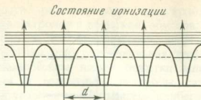
Рис. 2. Энергетическая схема кристалла в виде периодически расположенных потенциальных ям, разделенных потенциальными барьерами
