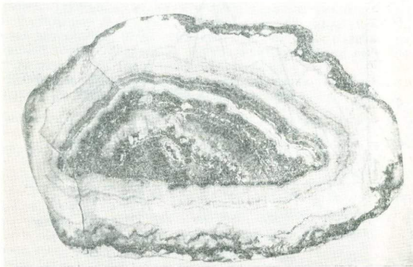
Рис. 4. Тонкополосчатое чередование свободного кремнезема с редкой вкрапленностью пирита и полос с мелкими кристаллами пирита и блеклой руды.
